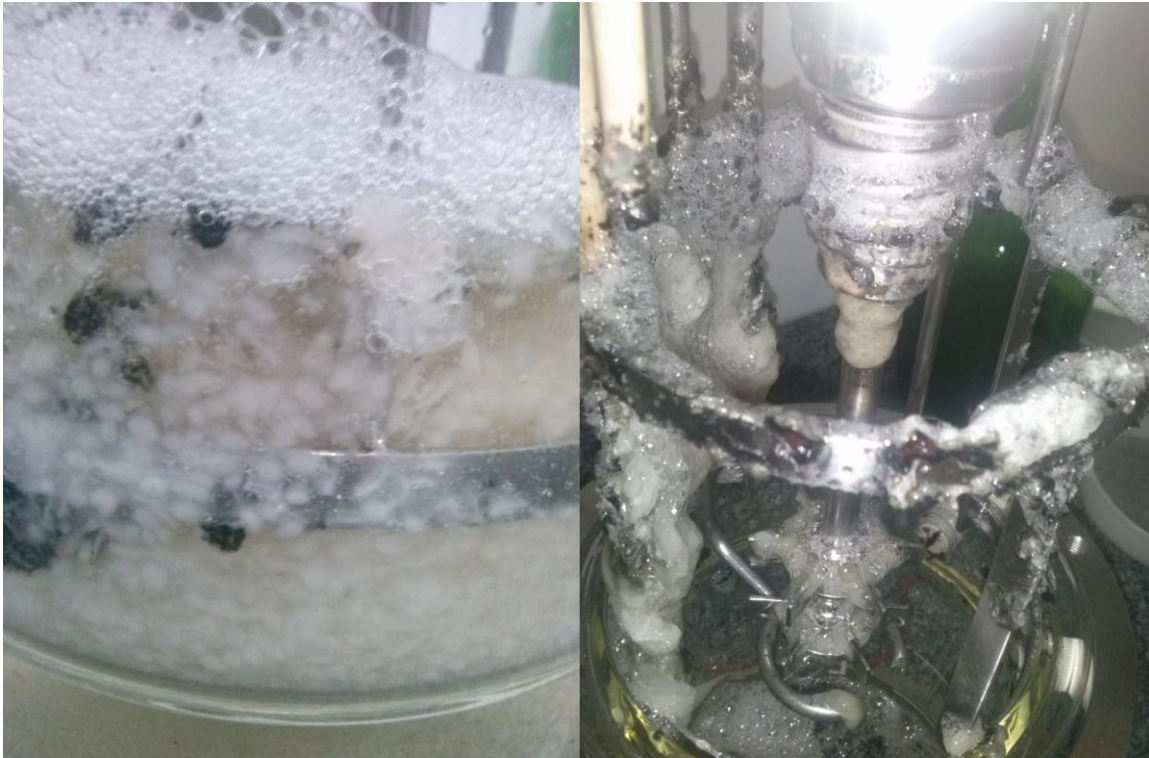
Figura 5: Biomassa fúngica e EPS em meio formulado com fonte de carbono e nitrogênio, ao término do processo fermentativo dentro do biorreator.
