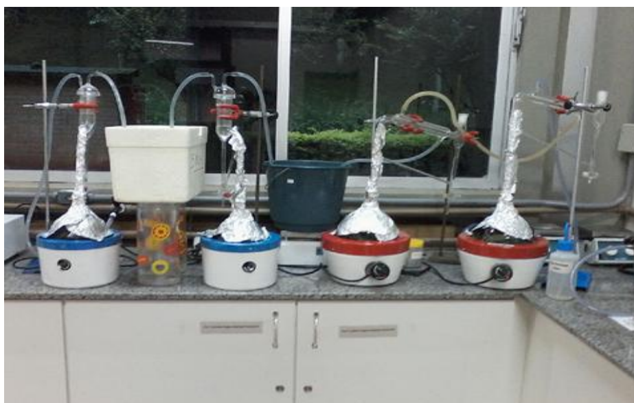
Figura 3 - Sistema de obtenção de óleo essencial por hidrodestilação, utilizando 4 aparelhos de Clevenger.
