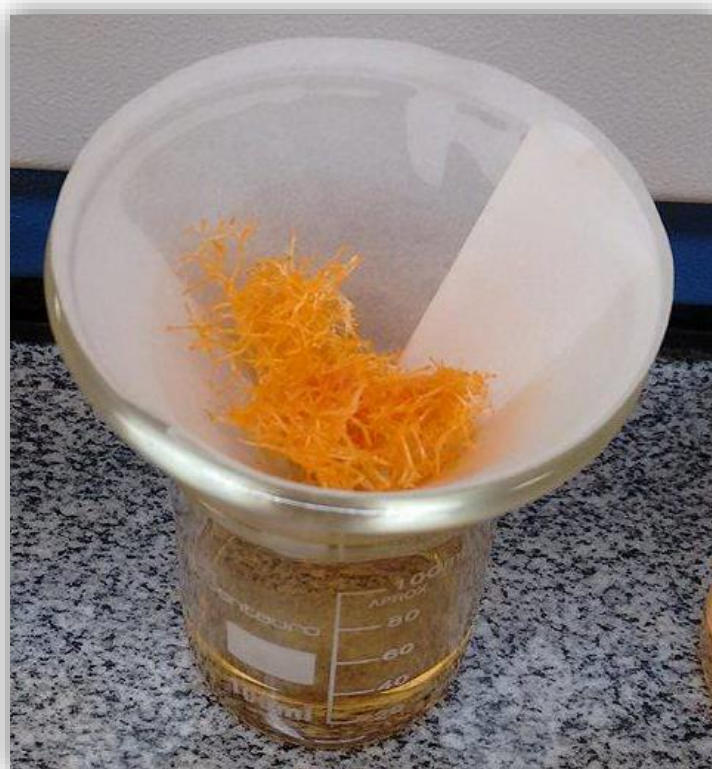
Figura 4 - Ensaio preliminar do corante laranja reativo BF-GR em bucha vegetal ( L. cylindrica ).
