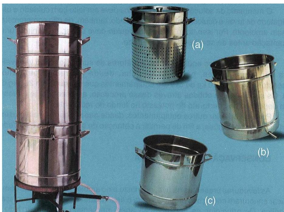
**Figura 8 – Extrator de suco de uva: a) recipiente com tampa para colocar a uva; b) recipiente do suco; c) depósito de água.**
