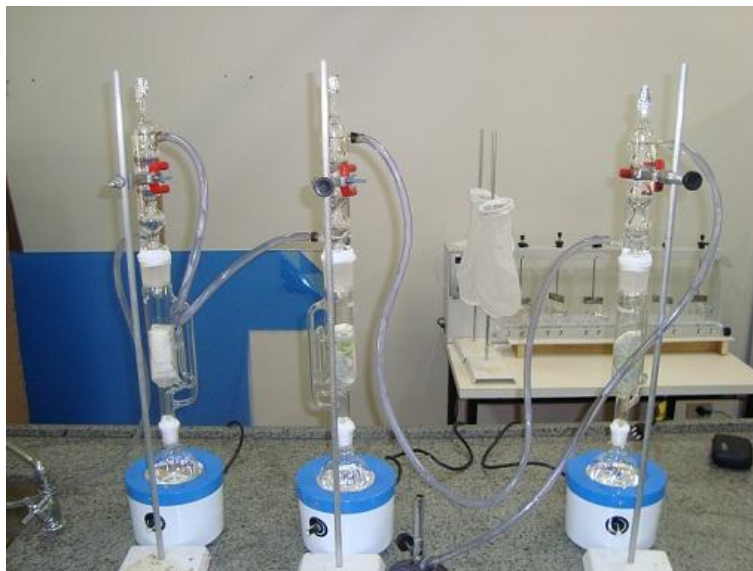
Figura 7 – Aparelho de Soxhlet utilizado na extração. Fonte: Próprio autor.
