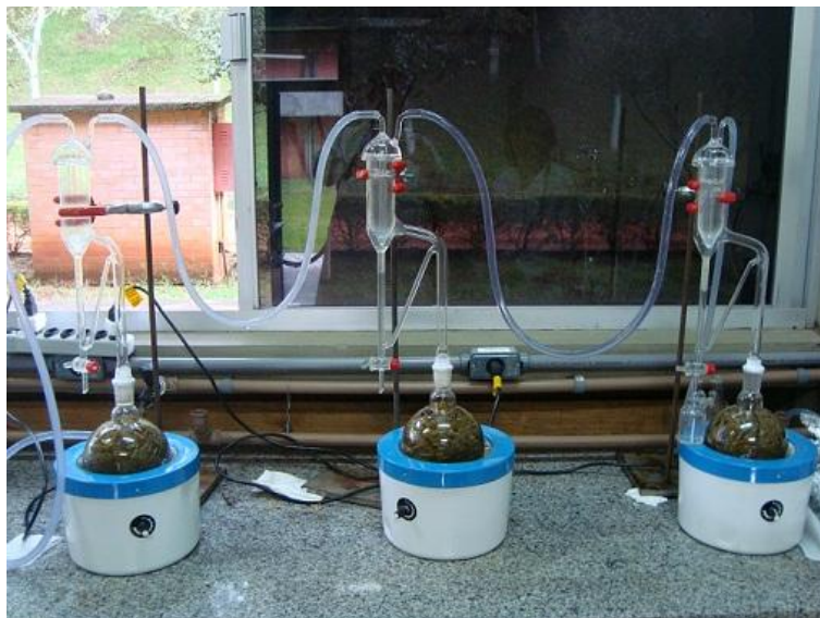
Figura 6 – Aparelho de Clevenger utilizado na extração. Fonte: Próprio autor.
