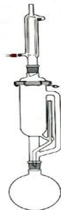
Figura 2 – Aparelho de Soxhlet utilizado para extração por solvente. Fonte: Gomes e Oliveira. (2000).
