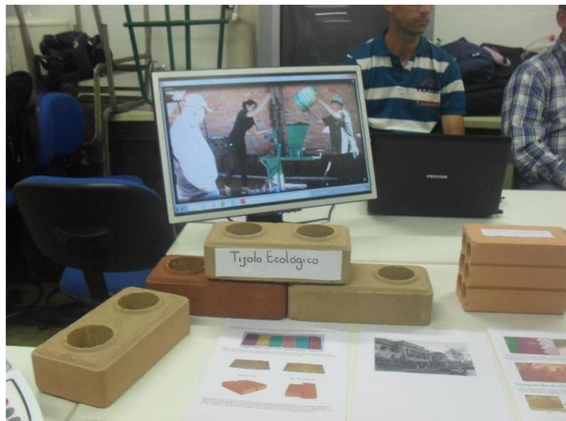
**Imagem 8: apresentação do vídeo demonstrando a produção do tijolo de solo- cimento, o tijolo de solo-cimento e o tijolo convencional feito de barro ou argila cozida**
