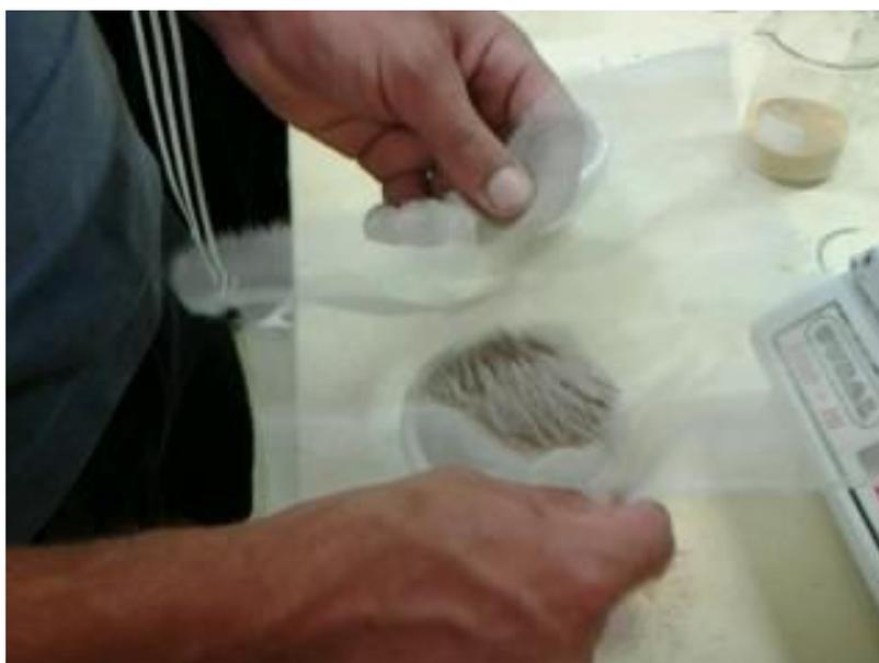
**Imagem 16: peneiração com auxílio de uma tela de nylon.
