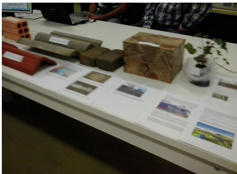
**Imagem 13: amostras da telha de concreto (ecológica), telha de barro cozido (convencional), do paver de concreto poroso, utilização do papel filtro reciclado como forração de paredes e um exemplar de uma planta ideal para telhado verde.
