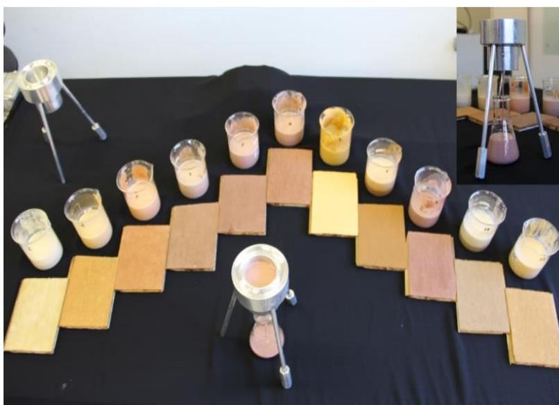
**Imagem 22: Análise de viscosidade e aplicação de tintas obtidas a partir de diferentes “solos”
