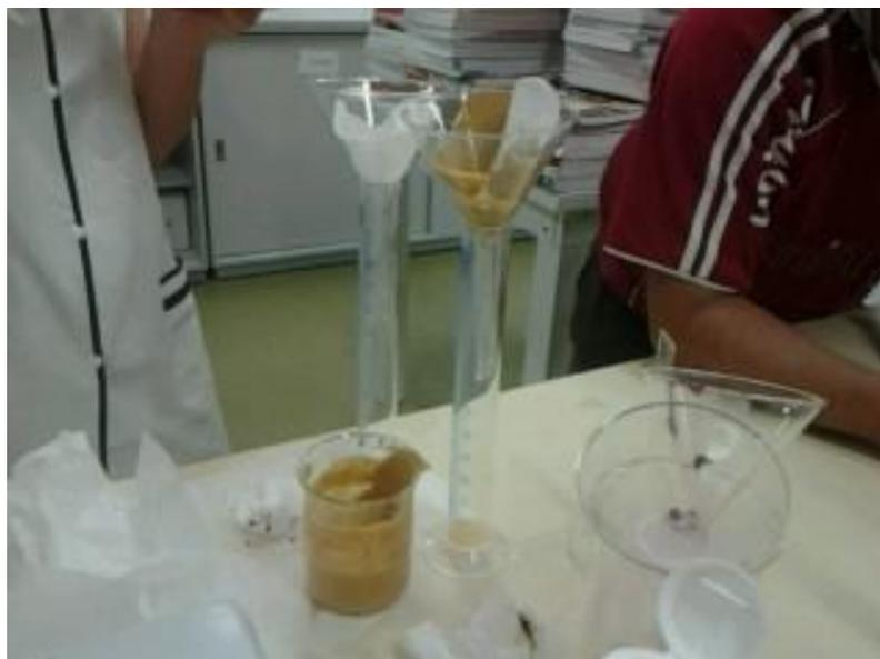
**Imagem 20: filtragem em gaze para separação da solução sobrenadante**
