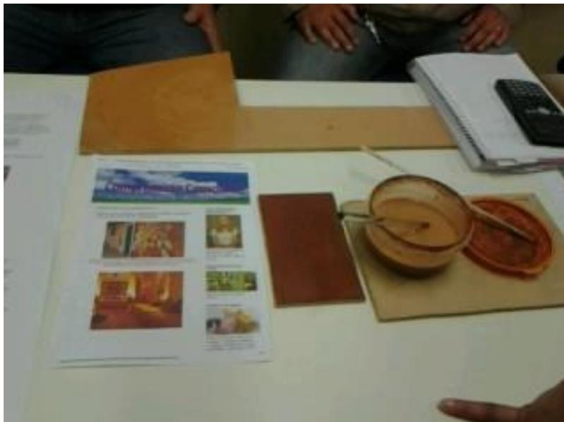
**Imagem 10: tintas produzidas a partir de solos e placas de teste de aplicação.
