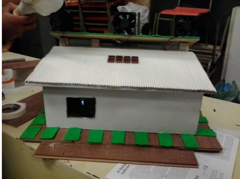
**Imagem 2: circulação de ar, telhado refletivo e pastilhas representando painel fotovoltaico
