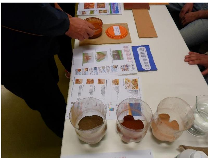
**Imagem 9: solos utilizados para a produção das tintas e ilustrações de utilização.
