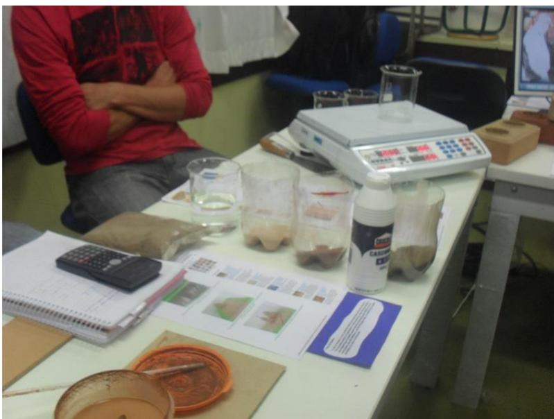
**Imagem 11: amostra das tintas à base de solo, materiais utilizados e demonstrativo de produção e imagens ilustrativas de utilização.
