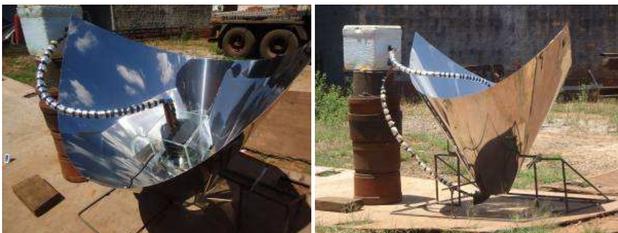
Figura 18 - Fotos do teste com o reservatório (20 litros)
