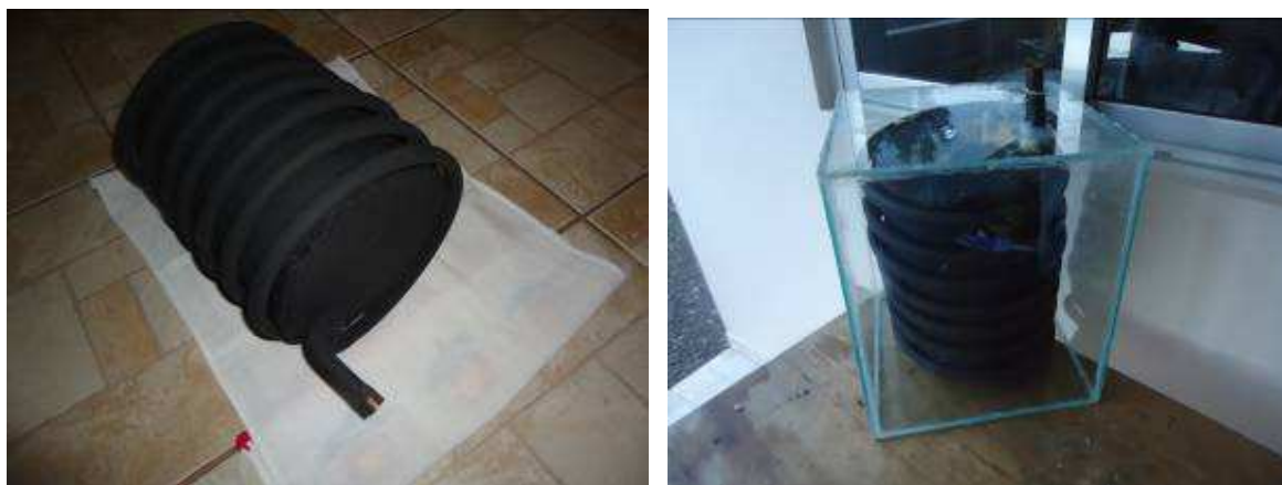
Figura 7 - Acumulador 1 antes e depois da montagem
