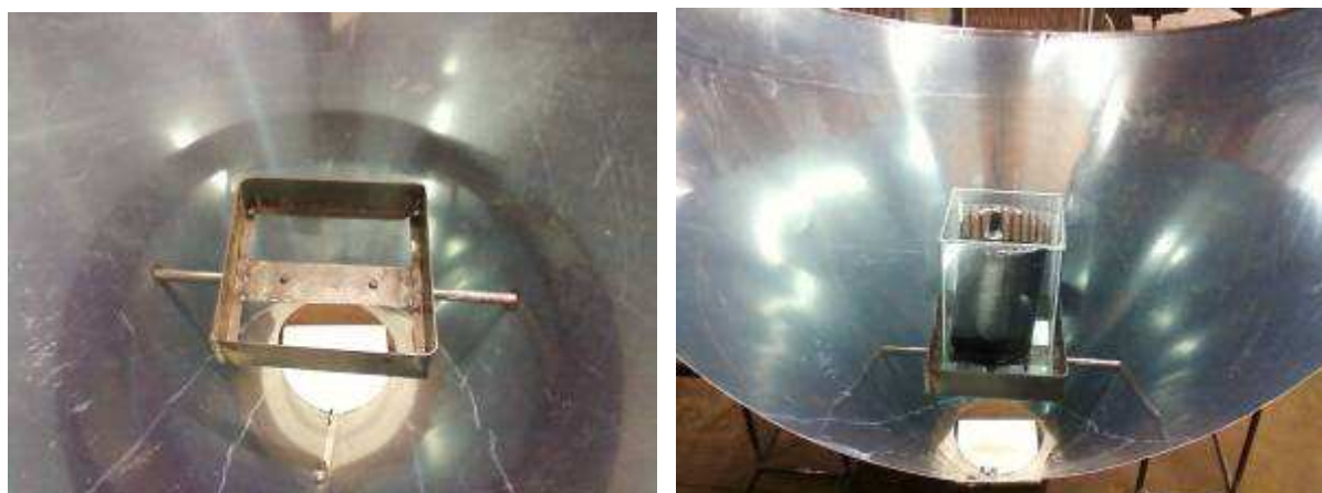
Figura 10 - Suporte do acumulador térmico
