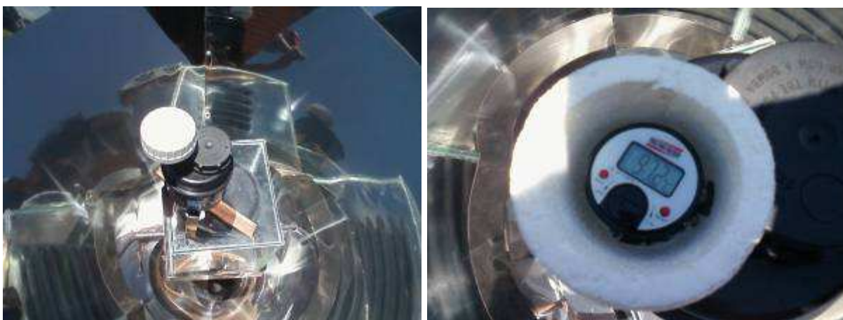
Figura 16 - Interior do cone e zoom do termômetro
