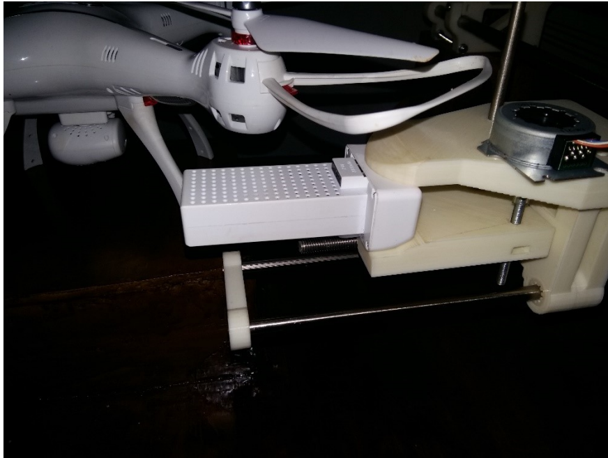
Figura 35 – Deslocamento da bateria.
