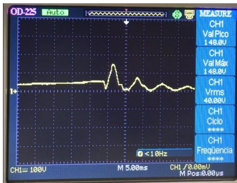
Figura 33: Gráfico de tensão encontrada no sistema sem cargas e com sinais DC dispendo de três transdutores em paralelo.
