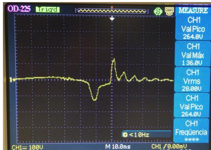
Figura 31: Gráfico de tensão encontrada no sistema sem cargas e com sinais AC.
