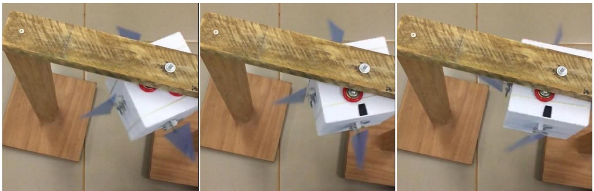
Figura 38: Deflexões encontradas das vigas em relação ao sistema sem massa de prova.
