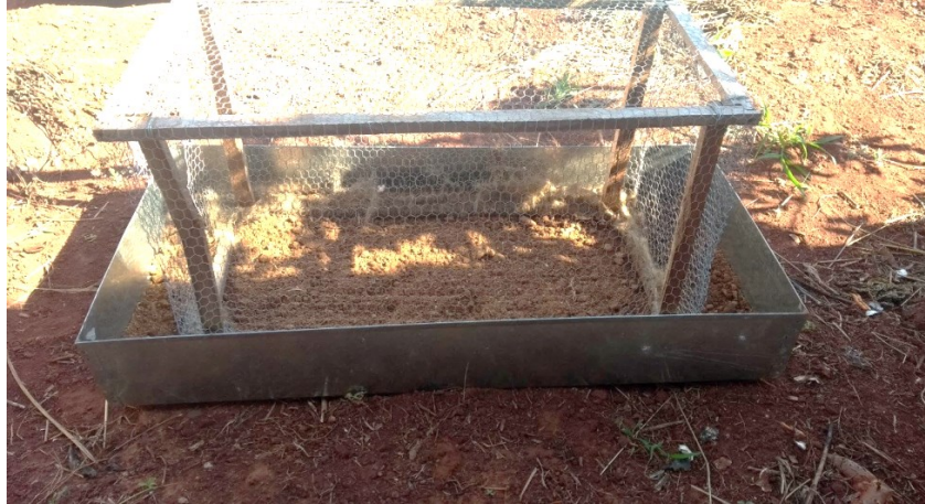
Figura 2 – Fotografia da dentro de uma bandeja de metal de 1 x 0,5 x 0,18 m (comprimento, largura e altura) contendo areia e serragem armação de madeira com 0,9 x 0,45 x 0,40 m (comprimento, largura e altura) revestida com tela de aço. Fonte: Autoria própria (2017).
