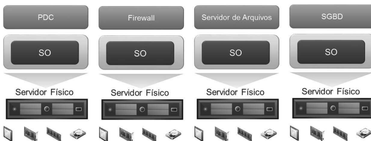
Figura 5 - Infraestrutura tradicional de TI (servidores dedicados) Fonte: Adaptação de VMware Visio stencils
