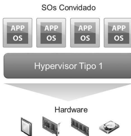
Figura 2 - Hypervisor tipo 1 Fonte: Adaptado de Laureano (2006)
