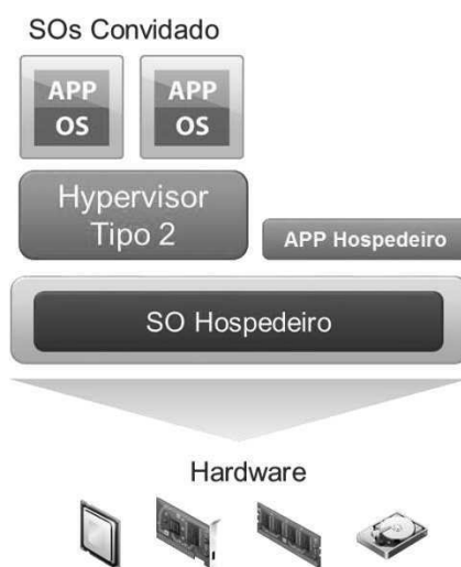
Figura 3 - Hypervisor tipo 2 Fonte: Adaptado de Laureano (2006)
