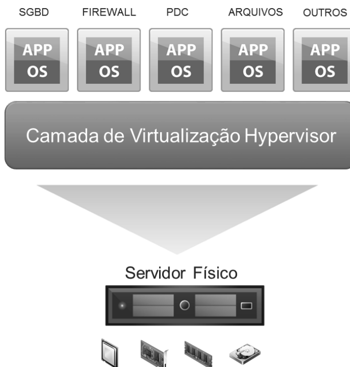
Figura 6 - Infraestrutura de TI com ambiente virtualizado Fonte: Adaptação de VMware Visio stencils
