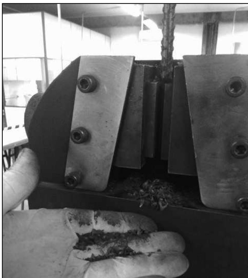
Figura 27 – Superfície danificada do corpo de prova
