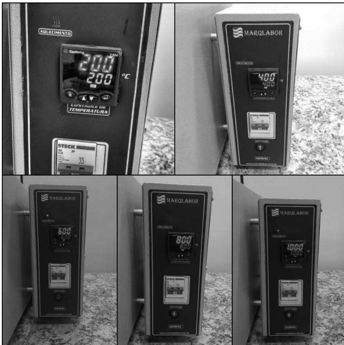
Figura 19 – Temperaturas atingidas durante o tratamento térmico das barras de aço
