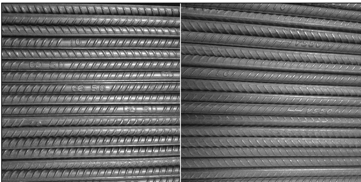
Figura 15 – Detalhe das marcas das barras de aço analisadas.
