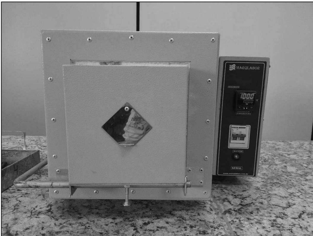
Figura 18 – Forno Mufla utilizado para realizar o aquecimento dos corpos de prova
