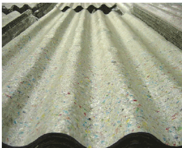
Figura 14 - Telha de tubo de creme dental Fonte: Casa com Design (2011).
