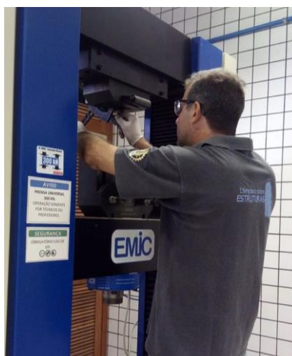
Figura 23 - Técnico do laboratório operando prensa universal durante ensaio de tração.
