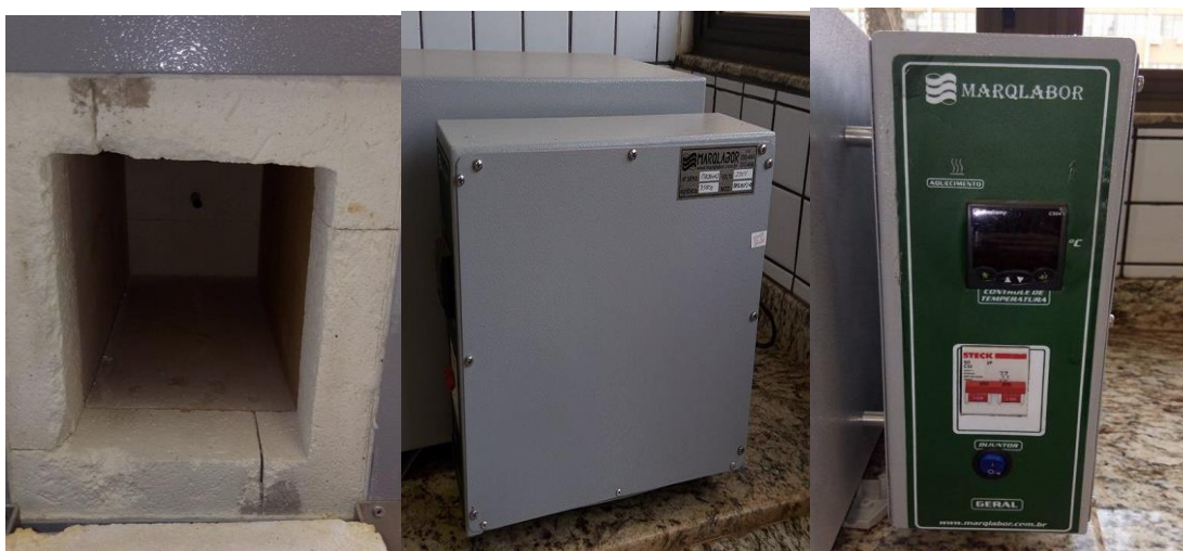
Figura 19 - Forno industrial (Temperatura máxima 1200 °C).
