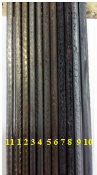
Figura 26 - Corpos de prova da marca Gerdau após aquecimento e resfriamento.
