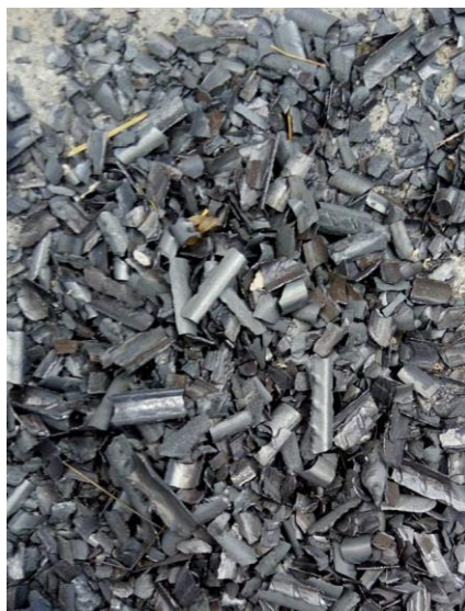
Figura 30. Desagregação das barras de aço a 1000 graus Celsius.
