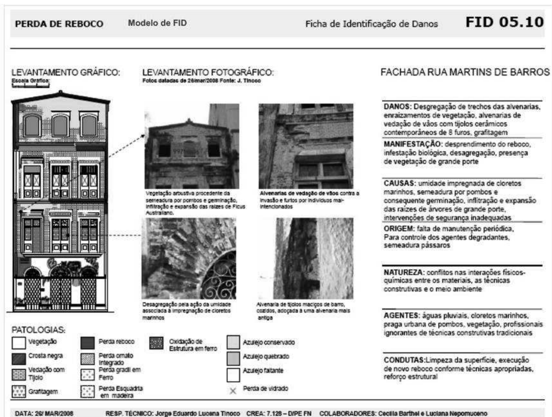
Figura 20: Exemplo de mapa de identificação de danos Fonte: Tinoco (2009).
