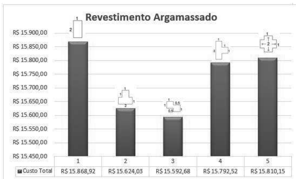
Figura 8: Comparativo de orçamento do revestimento argamassado
