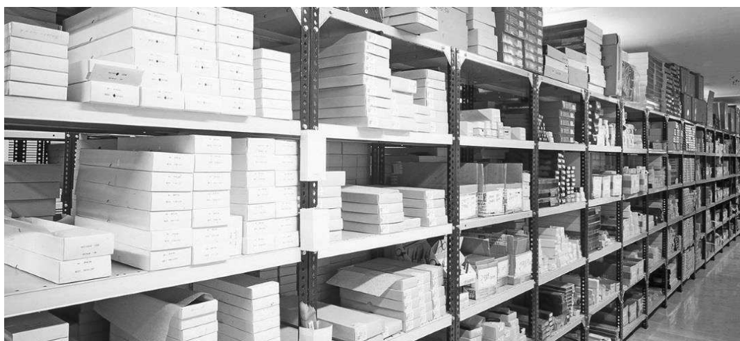
Figura 9: Sistema de armazenagem em cantoneira perfurada
