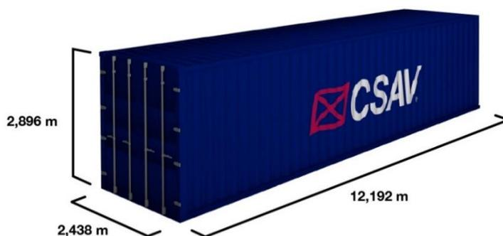
**Figura 5 - Dimensões externas modelo High Cube**
