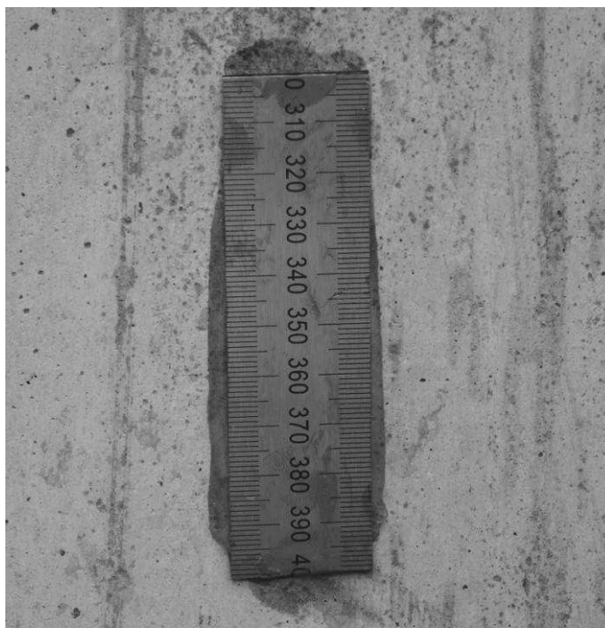
Figura 12 - Régua fixada nos pilares de referência Fonte: A autora (2015).
