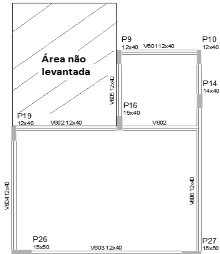
Figura 15 - Ilustração da Área Faltante na Laje de Cobertura. Fonte: Própria.
