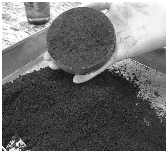
Figura 12– Amostra de solo rasada na altura do anel biselado.
