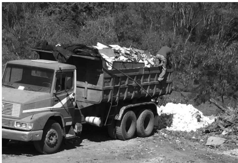
Figura 19 - Caminhão descarregando resíduos da construção civil sem separação prévia no aterro de inertes de Foz do Iguaçu Fonte: Elaborado pelo autor, 2017
