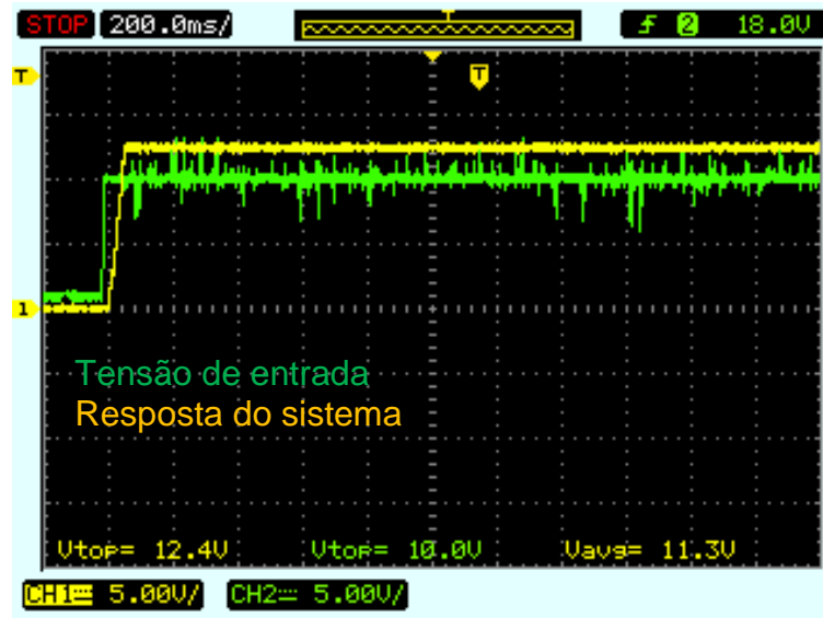
Figura 53 - Resposta do sistema para entrada de 10 V
