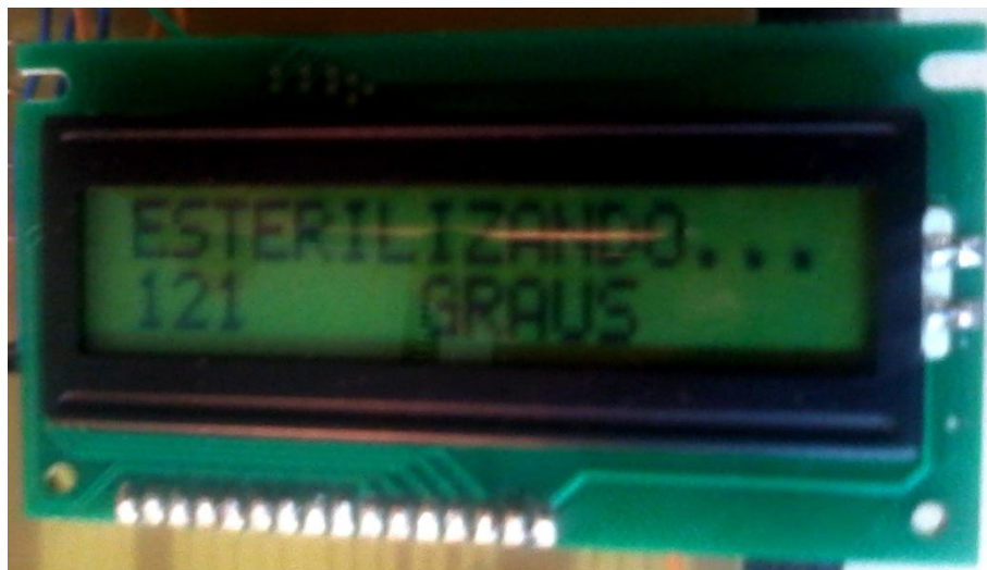
Figura 29 – Indicação da temperatura no display de LCD
