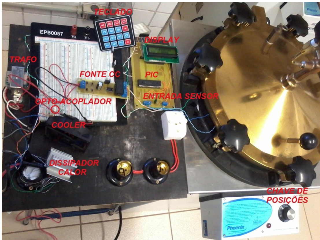
Figura 25 – Montagem do sistema de controle na autoclave
