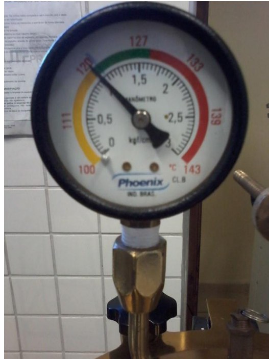
Figura 28 – Indicação da temperatura e pressão no manômetro da autoclave
