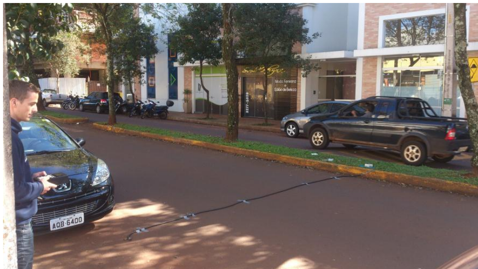
Figura 36: Montagem do equipamento de contagem automática em uma via.
