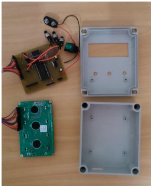
Figura 22: Dispositivo automático durante montagem dentro da caixa.
