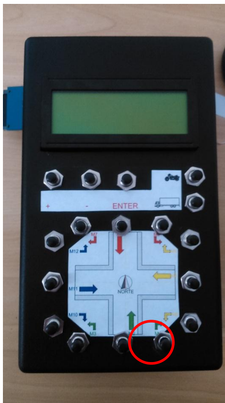
Figura 48: Botão pressionado durante operação pra adicionar um carro ao movimento 1 (M1).
