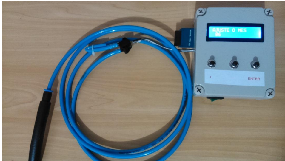
Figura 37: Detalhe do modo de engate rápido do sensor de pressão na mangueira.
