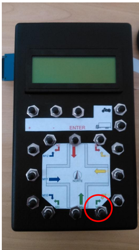
Figura 33: Botão pressionado durante operação pra adicionar um carro ao movimento 1 (M1).
