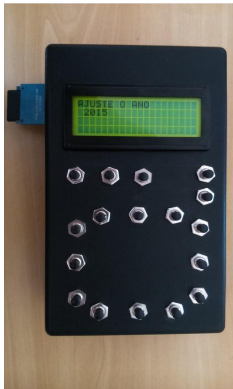
Figura 18: Dispositivo de contagem manual após montagem finalizada.
