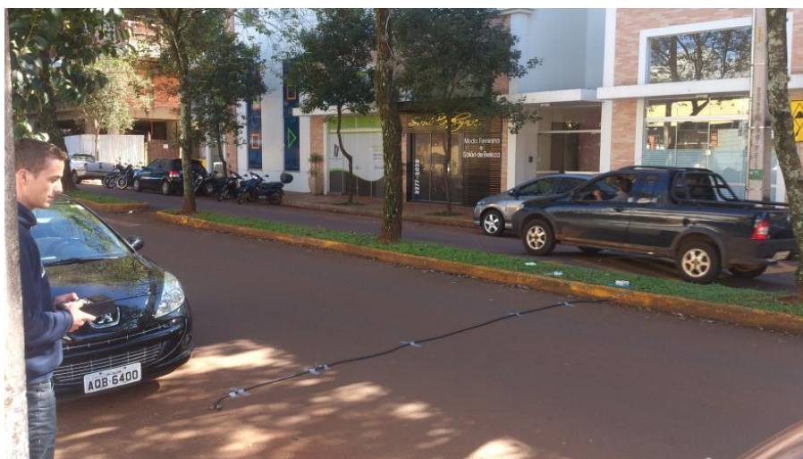
Figura 51: Montagem do equipamento de contagem automática em uma via.
