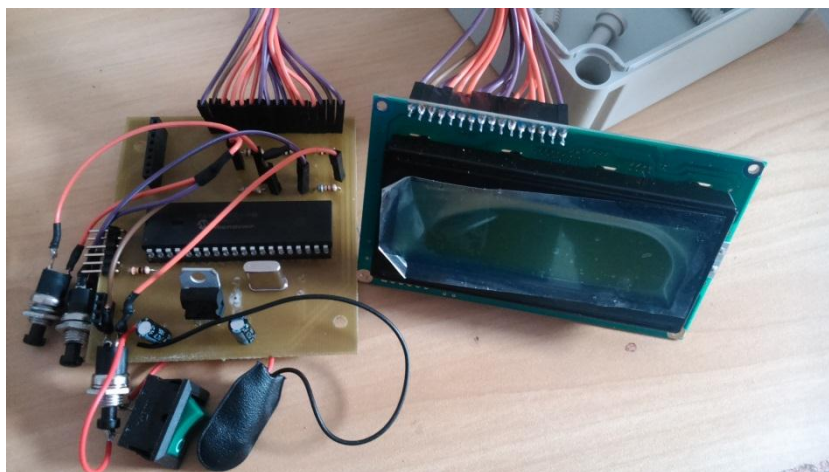
Figura 6: Microcontrolador PIC18F4550 ao centro da placa do dispositivo automático.
