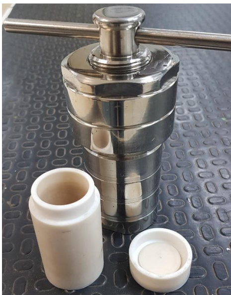
Figura 12 – Reator Hidrotérmico e recipiente de Teflon
