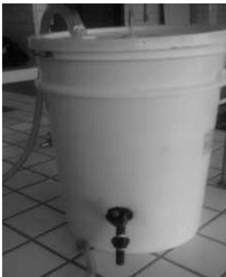
Figura 4. Biorreator utilizado nos 4 ensaios fermentativos.
