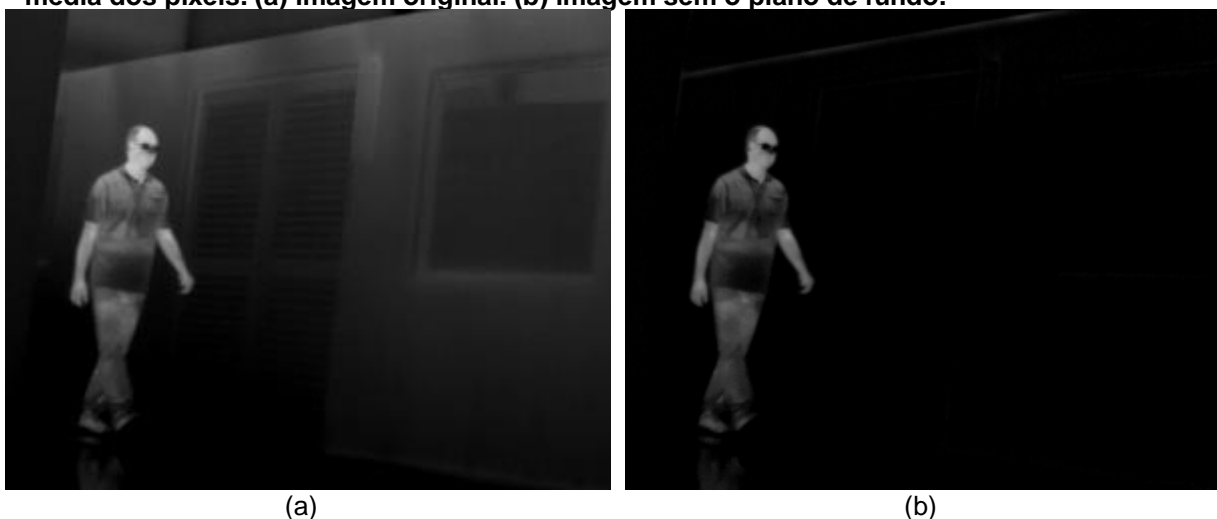
Figura 23 - Demonstração de uma imagem com o fundo removido a partir do cálculo da média dos pixels. (a) imagem original. (b) imagem sem o plano de fundo.
