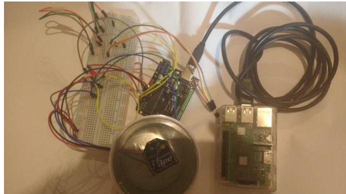
Figura 23 Conexão serial do Raspberry Pi com Arduíno
