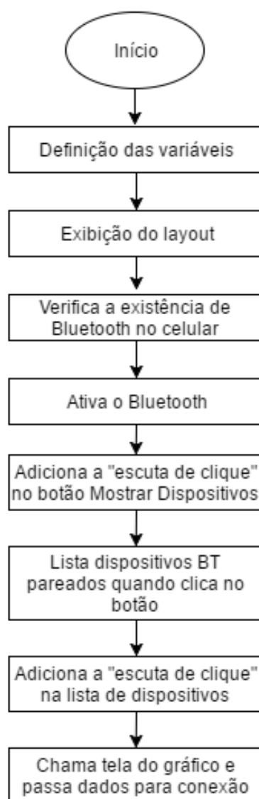
Figura 38: Fluxograma do DeviceList Fonte: Autoria própria
