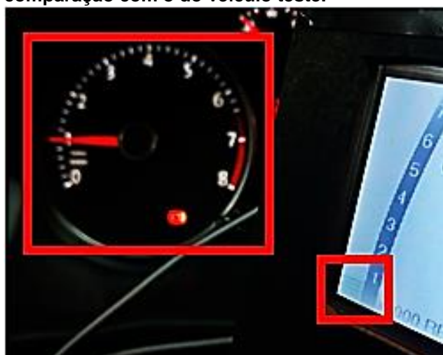
Figura 68: Validação da leitura através da comparação com o do veículo teste.
