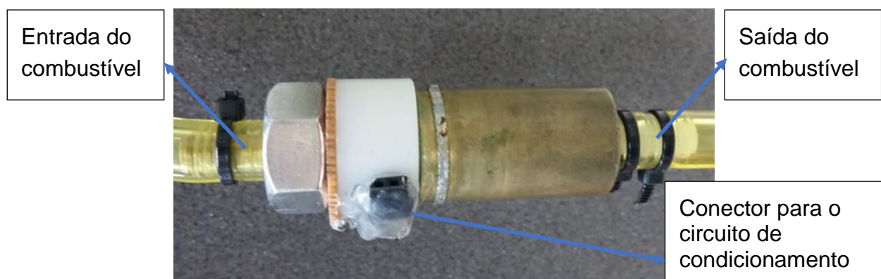
Figura 9 – Sensor capacitivo para combustíveis
