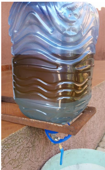
Figura 20 – Processo de separação da gasoline e etanol
