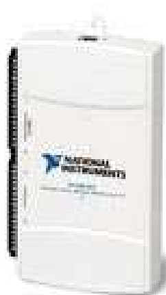
Figura 3 - Placa de aquisição de dados NI DAQ USB-6211 Fonte: National Instruments Corporation, 2012.
