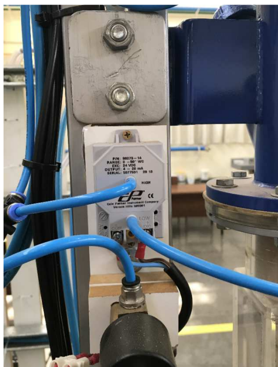
Figura 9 - Transdutor de pressão montado na planta. Autoria Própria - 2017
