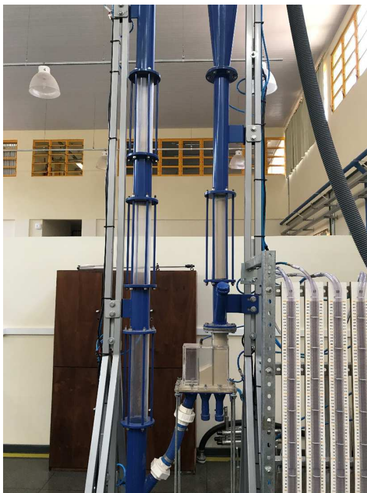
Figura 6 - Planta de ensaios de fluidização de partículas. Fonte: Autoria própria, 2017.
