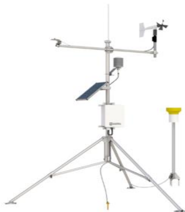
Figura 25 - Estação meteorológica GRWS100 Campbell Scientific Fonte: Campbell Scientific (2015)
