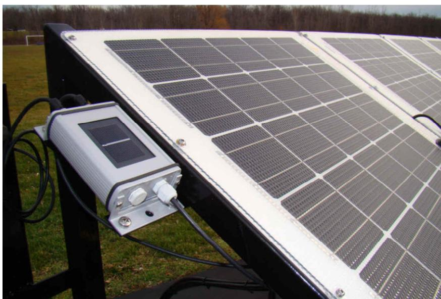
**Figura 3:** Sensor de silício para irradiação.
