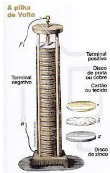
Figura 2 – Bateria de Volta.
