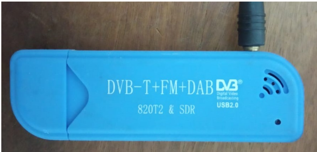
Figura 23 – Dongle DVB-T+DAB+FM utilizado para a medição do sinal de rádiofrequência da comunicação PLC.
