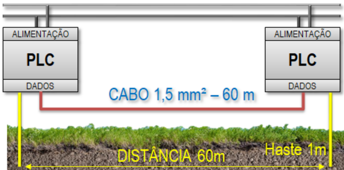
Figura 27 – Configuração do ensaio com transmissão por um cabo e aterramento.
