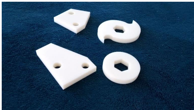
Figura 21 - Lâminas impressas na impressora 3D
