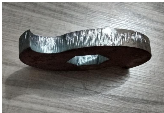
Figura 25 – Fotografia da lâmina rotativa mostrando as estrias causadas pelo corte a laser.
