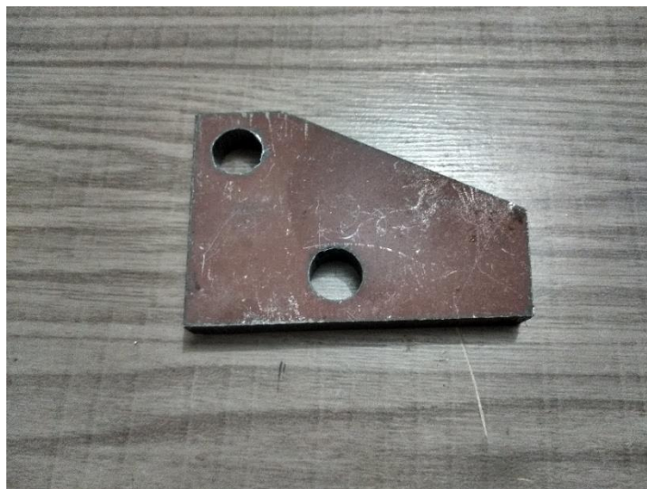
Figura 27 - Lâmina fixa B cortada a laser
