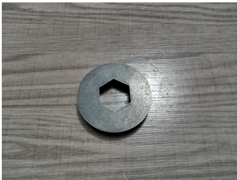
Figura 29 - Espaçador cortado a laser
