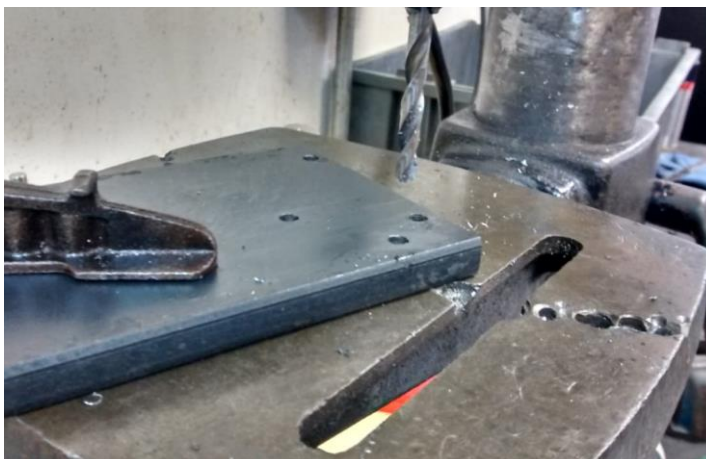
Figura 30 - Furação chapa lateral
