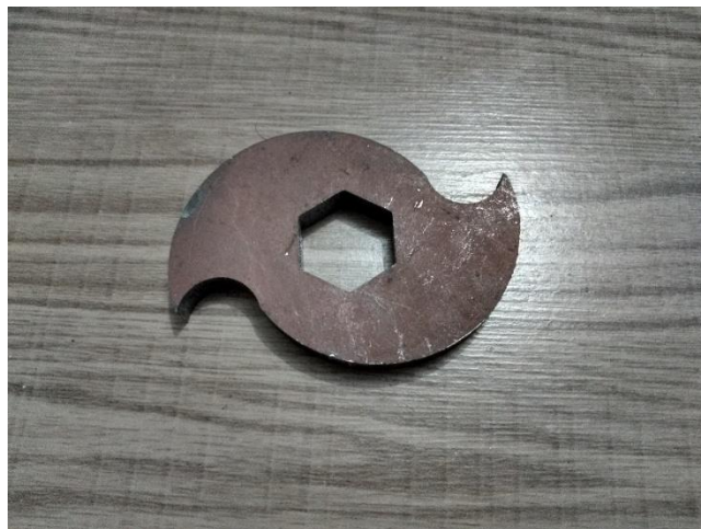
Figura 26 - Lâmina rotativa cortada a laser
