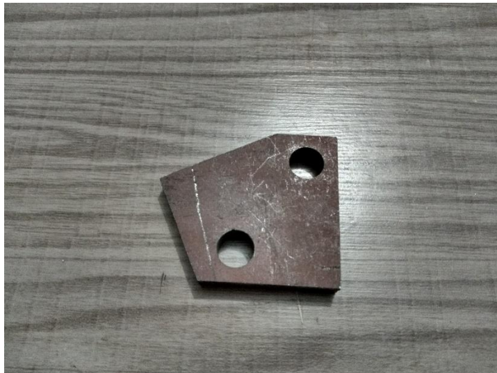
Figura 28 - Lâmina fixa A cortada a laser
