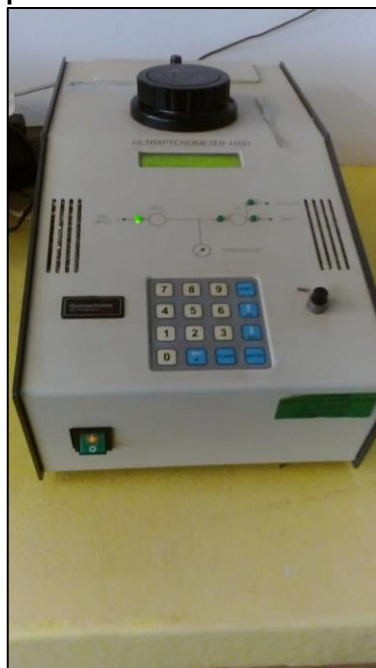
Fotografia 19 - Equipamento para Picnometria a Hélio.
