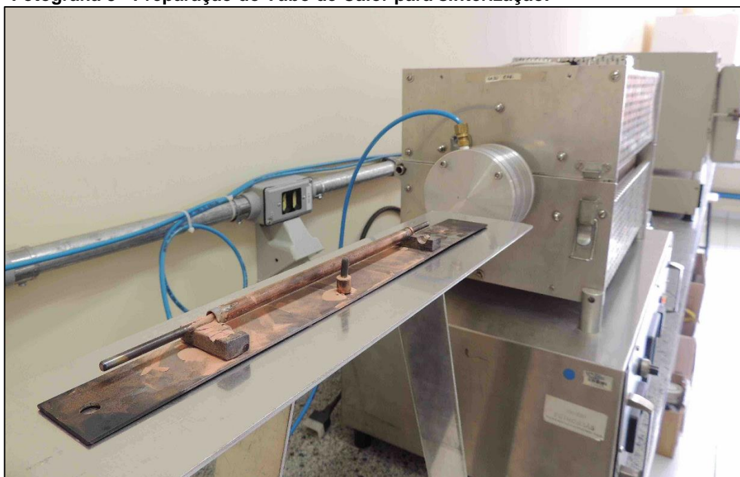
Fotografia 8 - Preparação do Tubo de Calor para sinterização.
