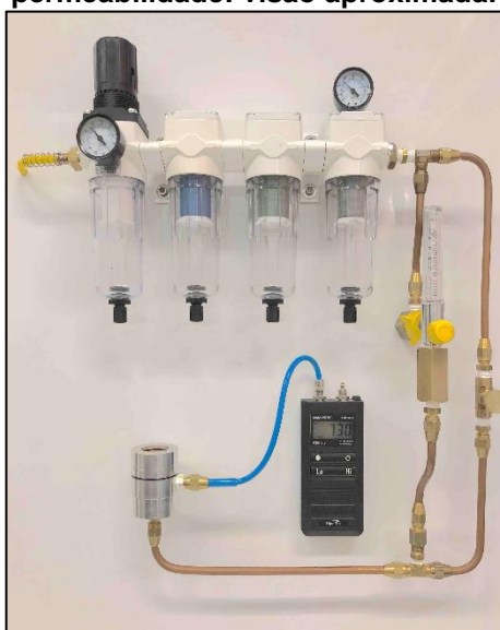
Fotografia 12 - Aparato de permeabilidade: visão aproximada.
