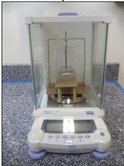
Fotografia 18 - Montagem para o Método de Arquimedes.
