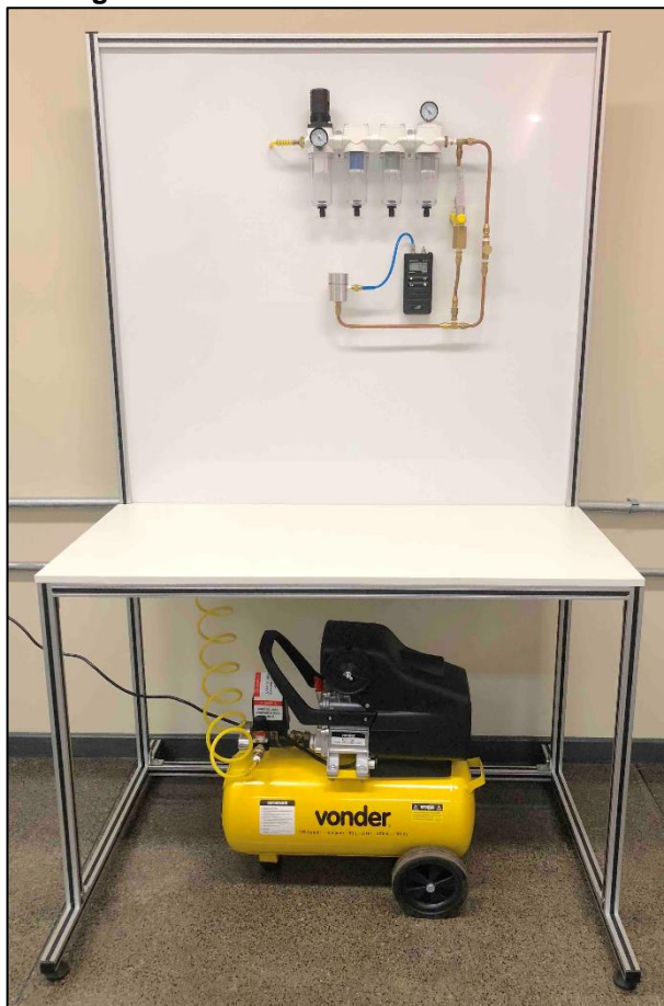
Fotografia 11 - Aparato de permeabilidade: visão geral.
