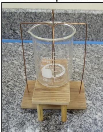
Fotografia 15 - Aparato para Método de Arquimedes.
