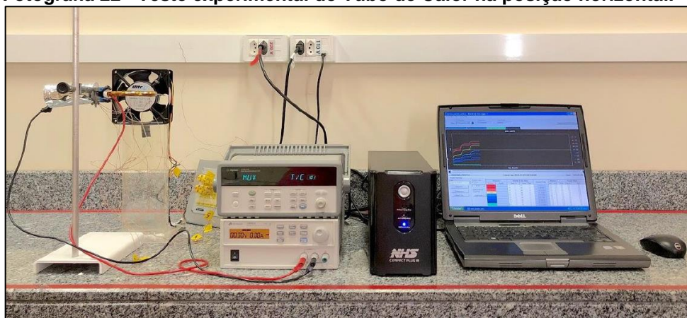
Fotografia 22 - Teste experimental do Tubo de Calor na posição horizontal.
