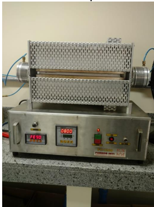
Figura 10: Forno com uma temperatura interna de 800°C
