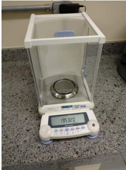
Figura 13: Balança de precisão utilizada para medição das massas dos corpos de provas.
