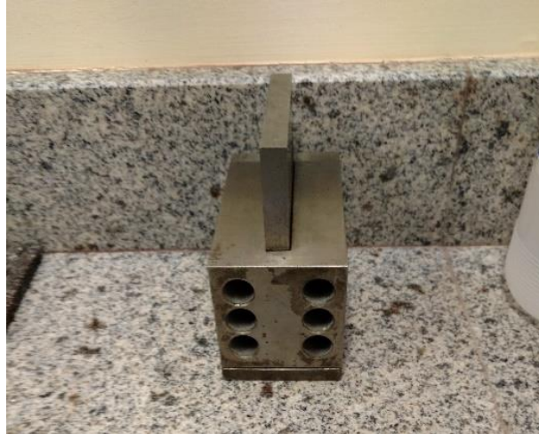
Figura 7: Molde metálico utilizado na compactação
