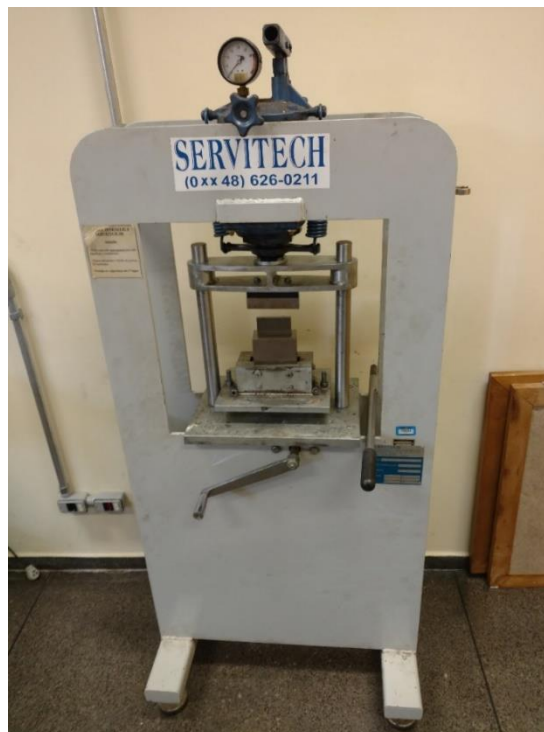
Figura 8: Prensa utilizada para compactação dos cavacos
