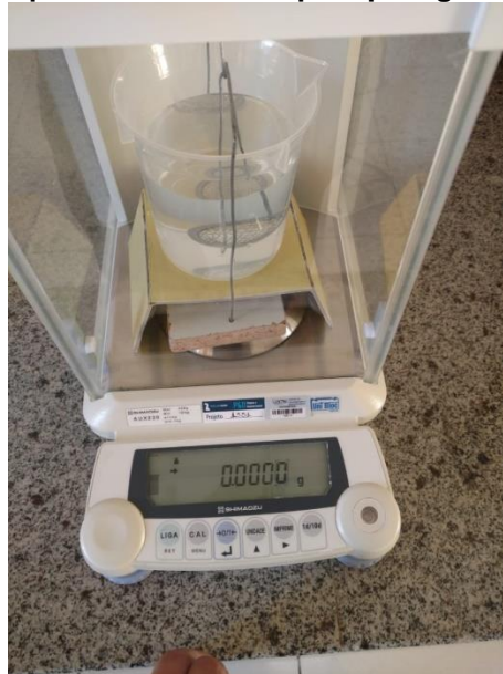
Figura 15: Esquema de Arquimedes montado para pesagem do corpo de prova imerso
