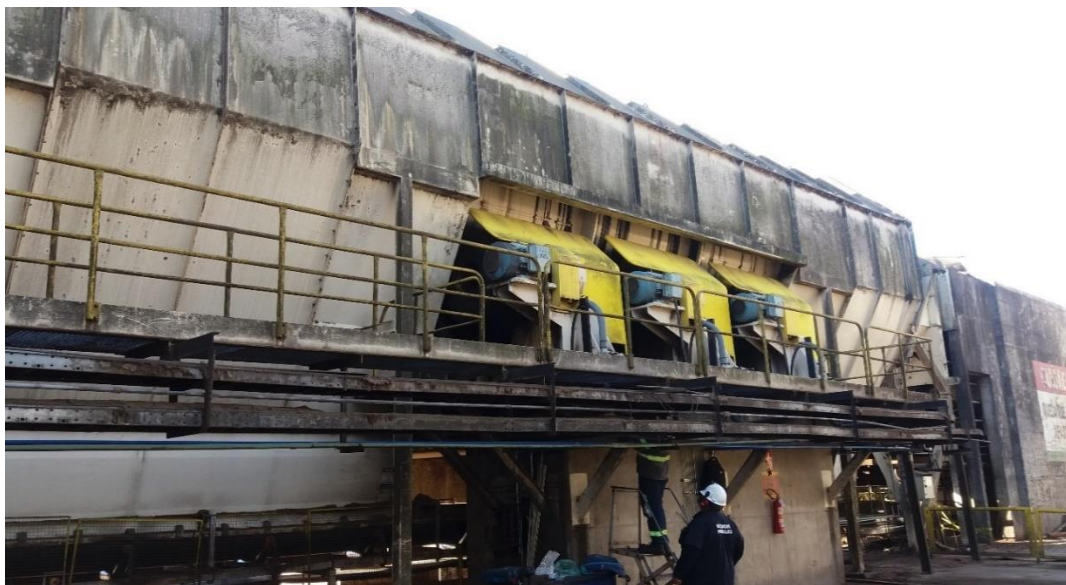
Figura 4 Tambor Descascador vista de fora mostrando sistema de alimentação do tambor
