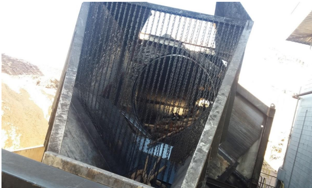
Figura 3 Tambor Descascador, vista frontal
