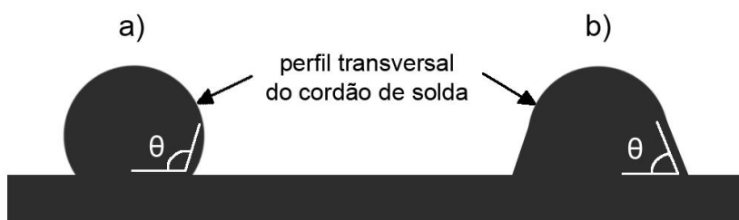
Figura 13 - Ângulo de molhabilidade. a) Ângulo positivo b) Ângulo negativo
