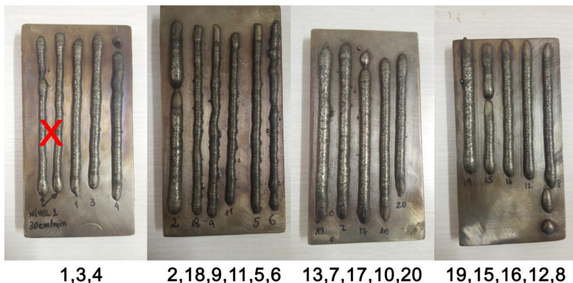
Figura 14 - Cordões de solda finalizados
