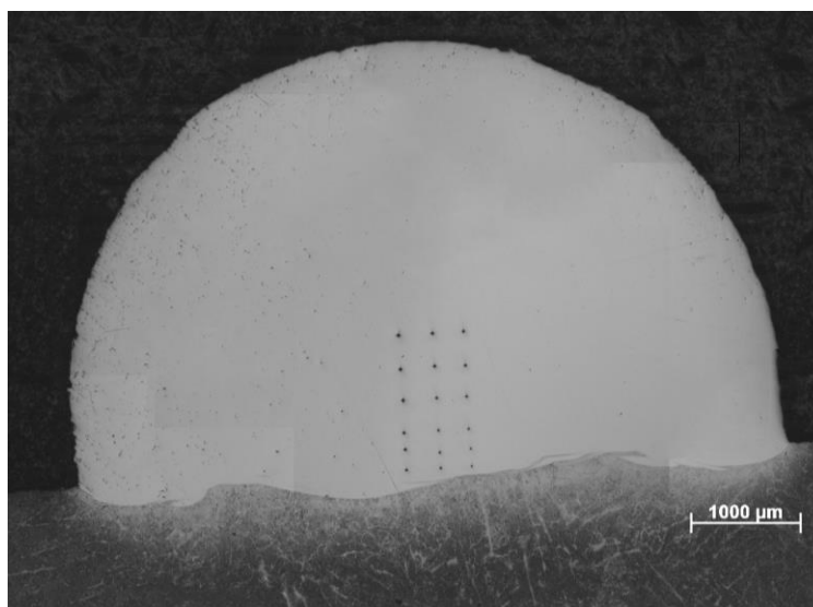
Figura 18 - Exemplo de medições de microdureza Vickers na amostra 01
