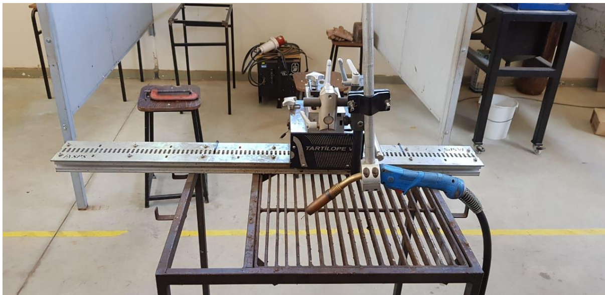
Figura 11 - Tartilope V1 posicionado com a tocha de soldagem MIG/MAG
