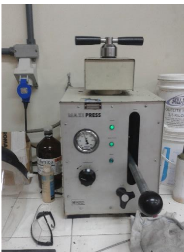
Fotografia 14 - Procedimento Embutimento à quente
