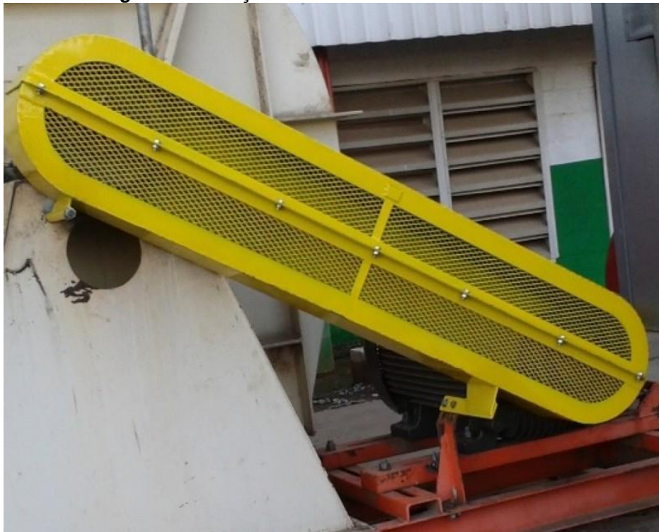
Figura 8 - Proteção do acionamento de um exaustor
