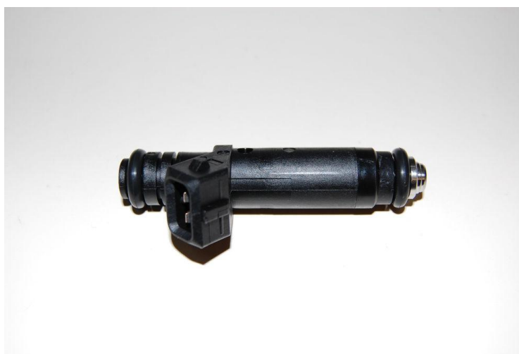
Fotografia 10 – Bico injetor de combustível Siemens-Deka 30 litros/hora. Fonte: autoria própria.
