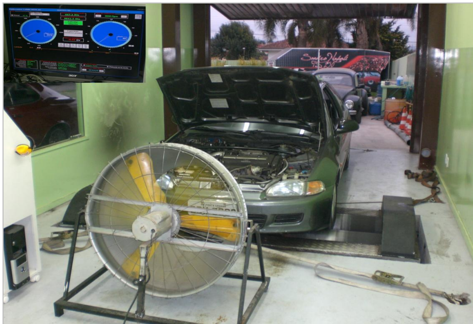
Fotografia 13 – Dinamômetro de chassi e veículo utilizado nos testes Fonte: autoria própria.
