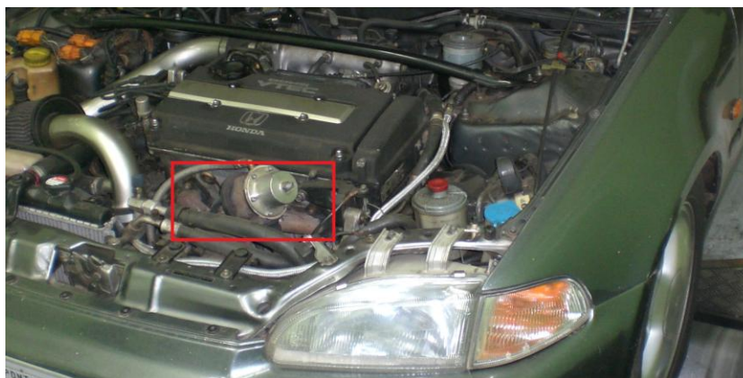
Fotografia 06 – Coletor dos gases de exaustão Fonte: autoria própria.
