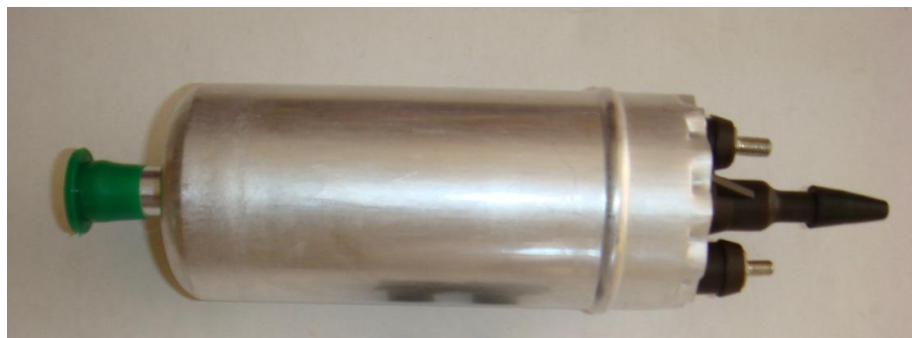
Fotografia 09 - Bomba de Combustível Bosch 580 (3 bars) 130 litros/hora Fonte: autoria própria.
