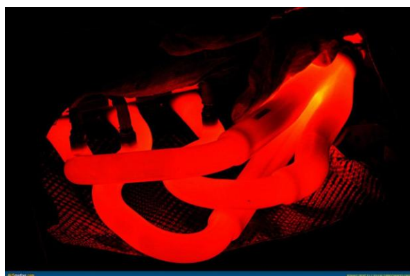
Fotografia 04 – Indicativo de temperatura no coletor dos gases de exaustão Fonte: Renault (2014).
