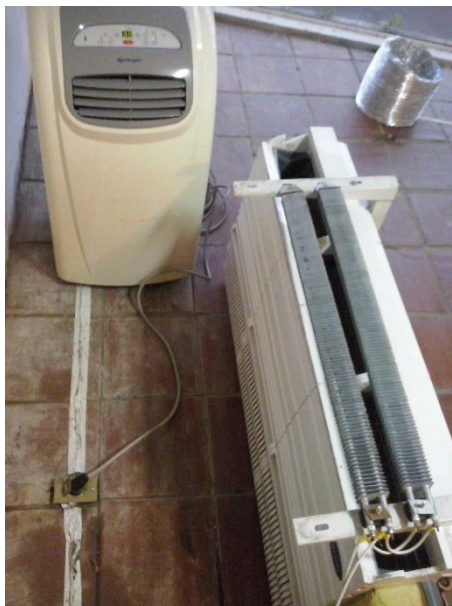
Figura 20 - Evaporador e ar condicionado de suporte.
