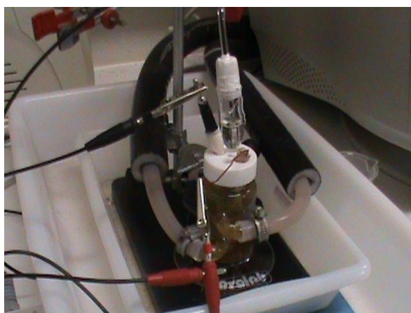
Figura 15: Célula Eletrolítica utilizada no ensaio eletroquímico Fonte: Autoria própria
