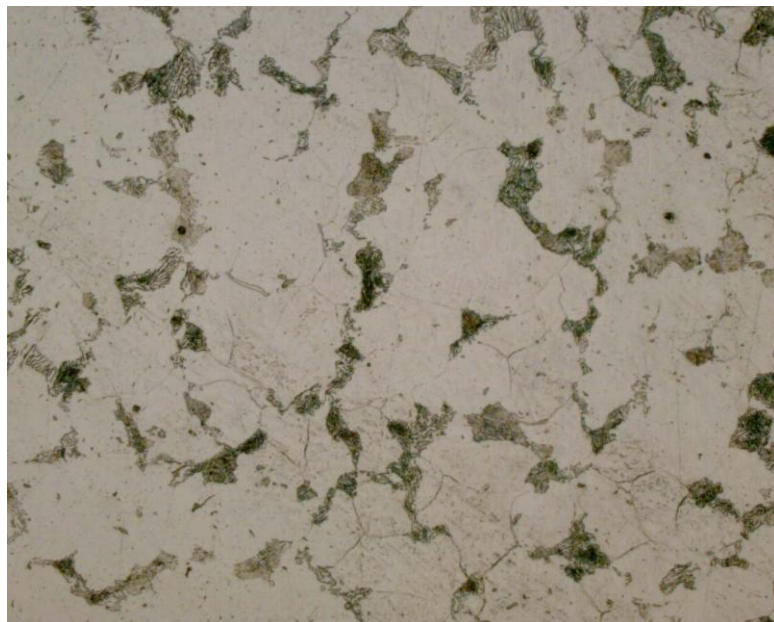
Figura 4: Micrografia de aço AISI1020 em corte transversal. (500x, Nital) Fonte: Autoria própria
