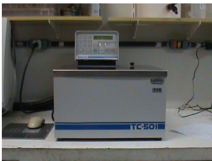
Figura 11: Termostato TC-501 Fonte: Autoria própria
