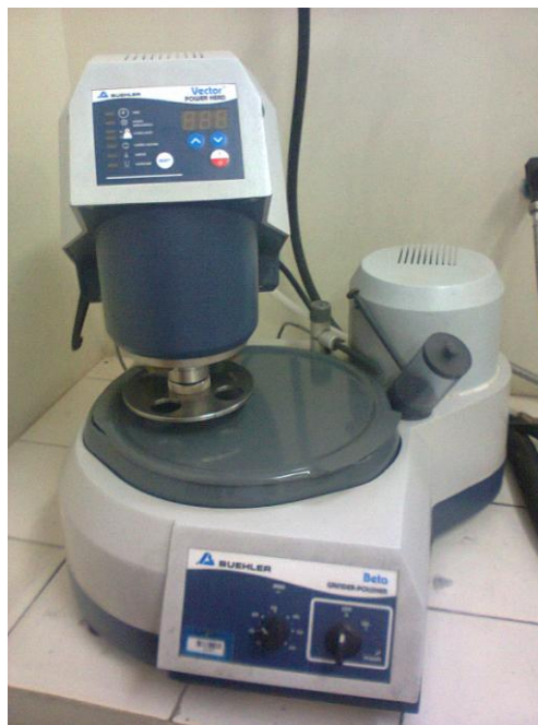
Figura 21 - Lixadeira e polítriz Buehler Beta. Fonte: autoria própria
