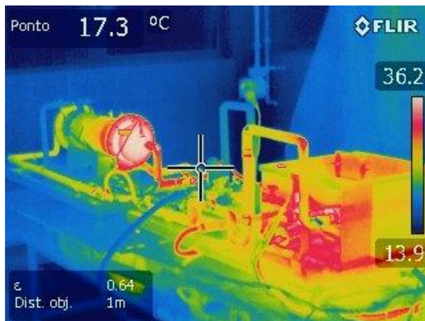
Fotografia 6 - Perdas de calor do aparato experimental para o ambiente externo. Fonte: Autoria própria.
