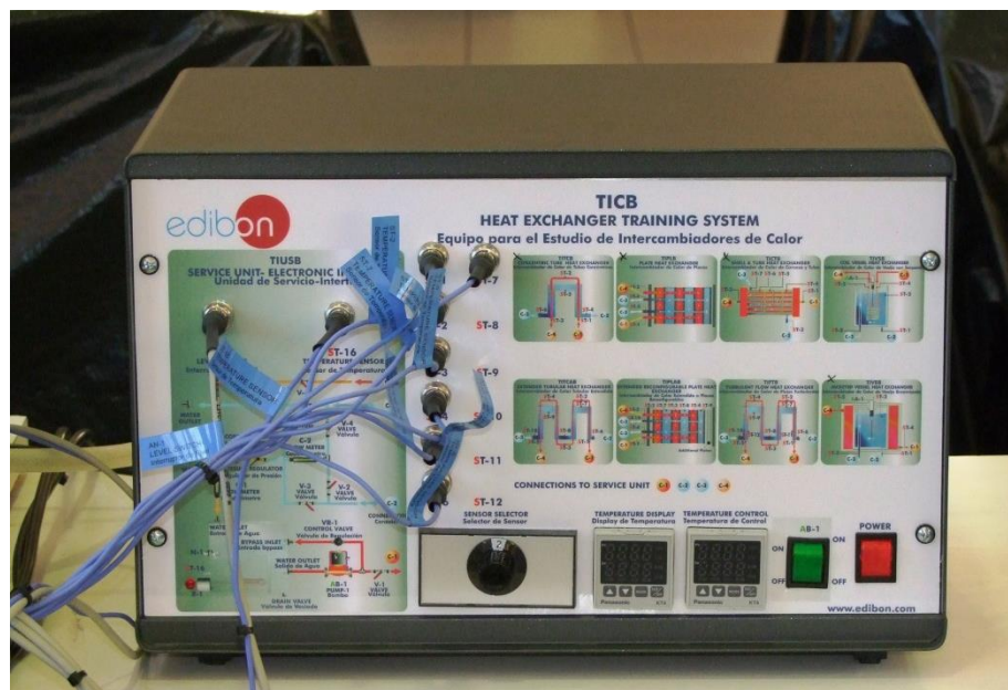
Fotografia 5 - Módulo de aquisição de dados SCADA. Fonte: Autoria própria.
