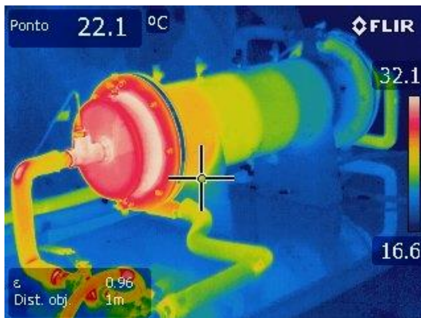
Fotografia 7 - Perdas de calor do trocador de calor do tipo casco e tubos para o ambiente externo. Fonte: Autoria própria.
