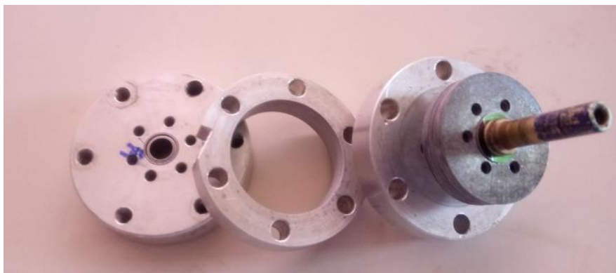
Fotografia 6 - Turbina Tesla e seus componentes
